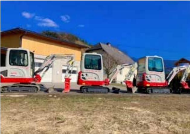
Zur Verfügung stehen drei neue Takeuchi Minibagger mit hydraulischen Schnellwechsler. Das heißt nicht mehr aussteigen beim Löffel wechseln und es ist jeder Löffel schwenkbar durch das Powertilt. Bagger: TB216: 1800 kg u. TB225: 2500 kg mit diversen Anbaugeräten wie z.B. Erdbohrer, Hydromeisel usw.
