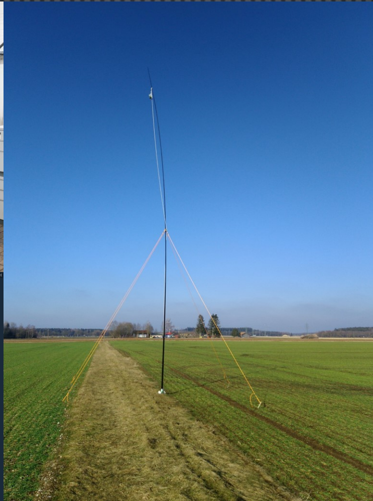
Aufbau für Reichweitenmessungen
